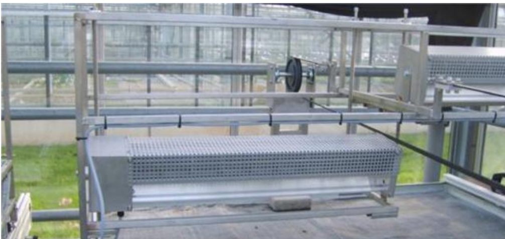
Abb. 1: Das Luftgebläse mit Befestigung an einem normalen Streichelwagen
